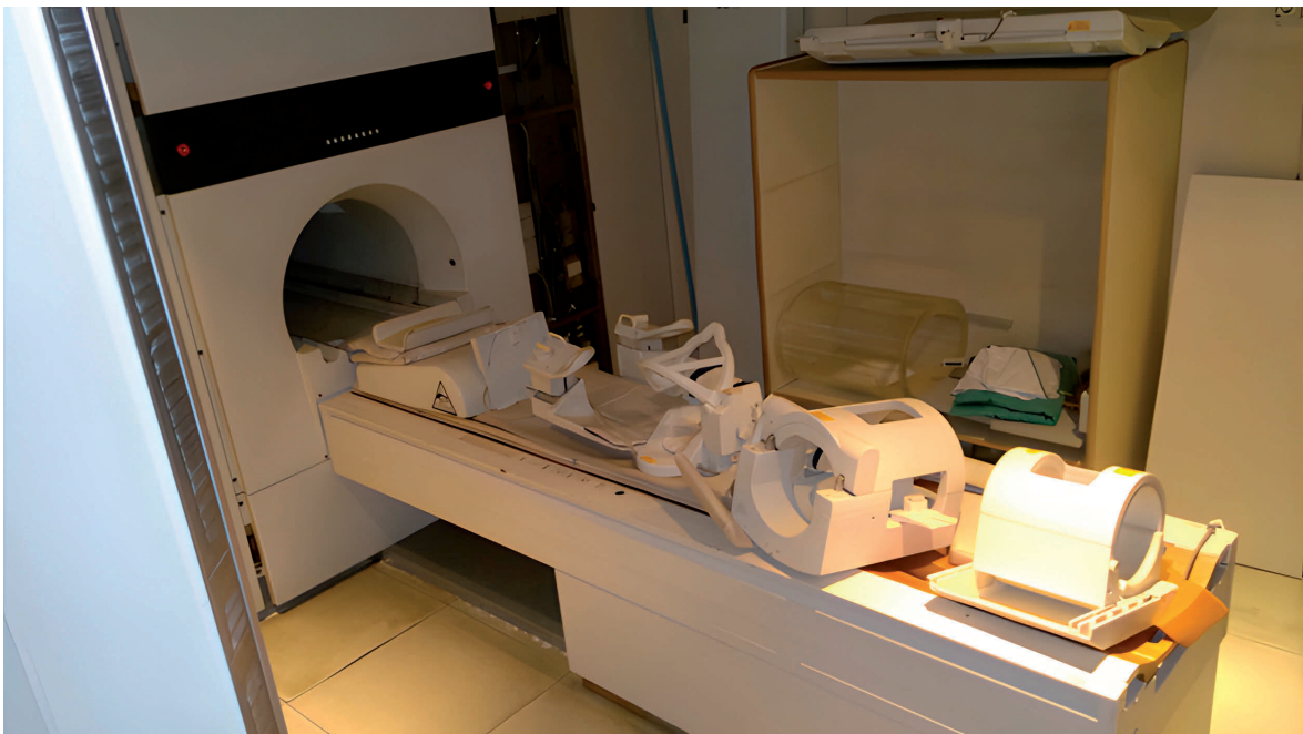
Fig. 8 Imagen tomada cuando se desarmó el primer equipo de RM del país, donde se aprecian algunas de las diferentes bobinas o antenas: (izq. a der.) hombro, temporomaxilar, cráneo, y rodilla
