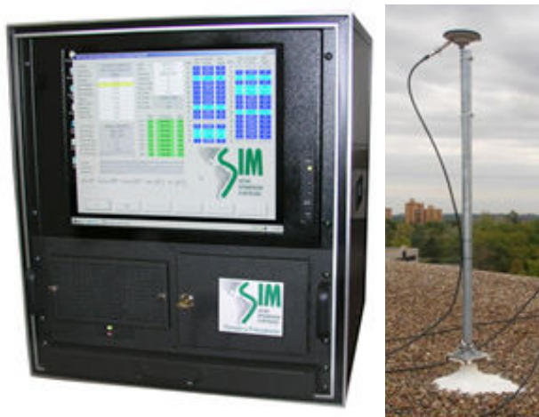
Fig. 5. Equipamiento para intercomparación de relojes patrones de Laboratorios Nacionales del SIM.
