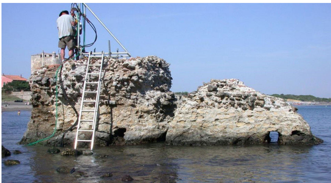
Perforación de una muestra de una antigua estructura de concreto romana en Portus Cosanus, Toscana, en 2003.
