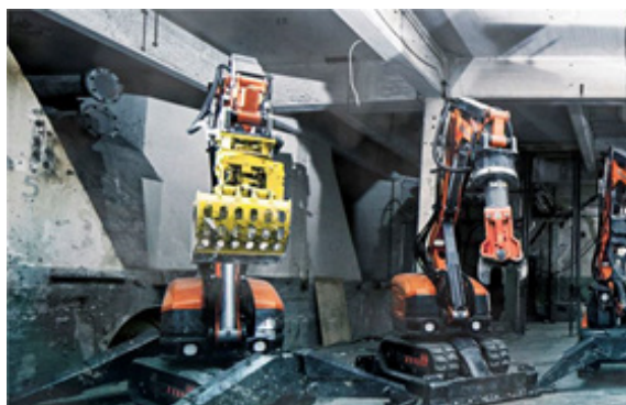
Figura 5. Excavadora robótica (DXR310 desarrollada por Husqvarna) con distintos accesorios incorporados
