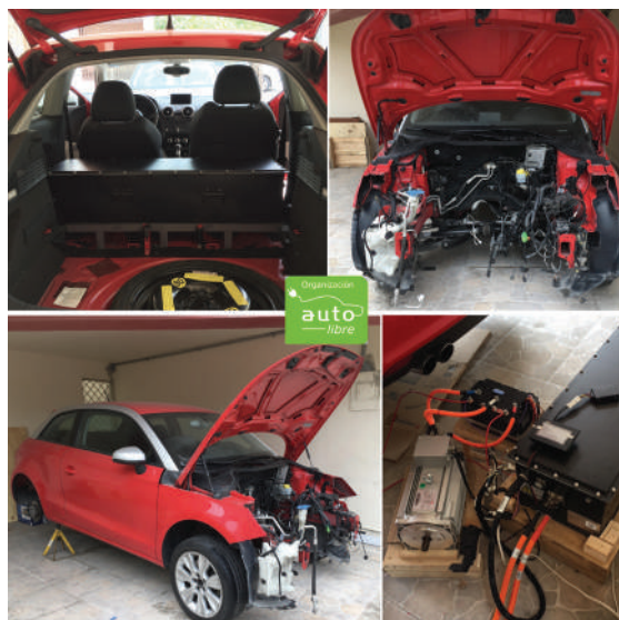
Armado de un Audi eléctrico con Litio NCM de 15 Kwh en taller Autolibre México.
