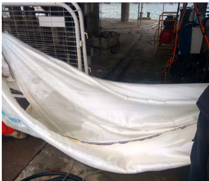
Figura 5. A la izquierda geotextil utilizado como encofrado. A la derecha geo – malla de refuerzo
