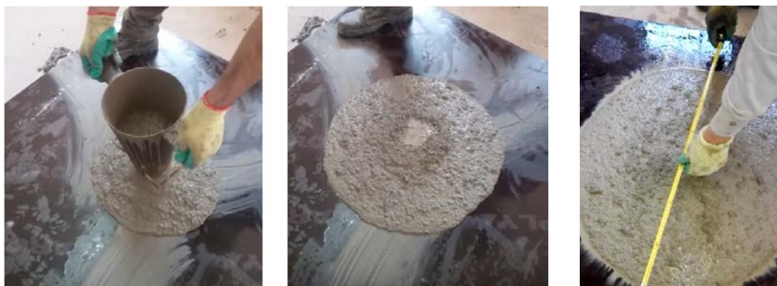
Figura 1 – Ensayo “cono invertido”, de flujo en pastón de prueba con 90 kg/m 3 de fibras metálicas.
