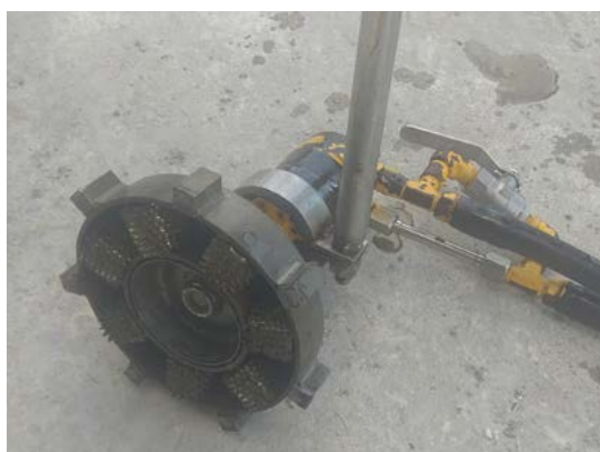
Figura 4. Amoladora neumática con disco de desbaste para limpieza superficial
